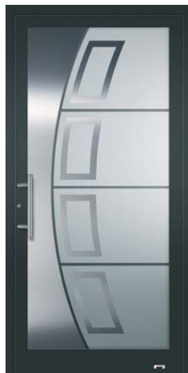
5457 Verglasung: Wärmeschutzisoliertglas, vorne: VSG beschichtet, Mitte: ESG mattiert mit klaren Streifen und NIRO-Design Applikationen, hinten: ESG, Oberfläche: FS Nightgrey ca. RAL 7016.
