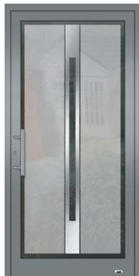
5459 Wärmeschutzisoliertglas, vorne: VSG beschicht- et, Mitte: ESG mattiert mit klarem Rand und Streifen in der NIRO-Design-Appli., hinten: ESG. Oberfl.: RAL 9007 Graualuminium matt
