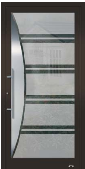
5456 Verglasung: Wärmeschutzisoliertglas, vorne: VSG beschichtet, Mitte: ESG mattiert mit klaren Streifen und NIRO-Design-Applikation, hinten: ESG, Oberfläche: MFS Sandbraun
